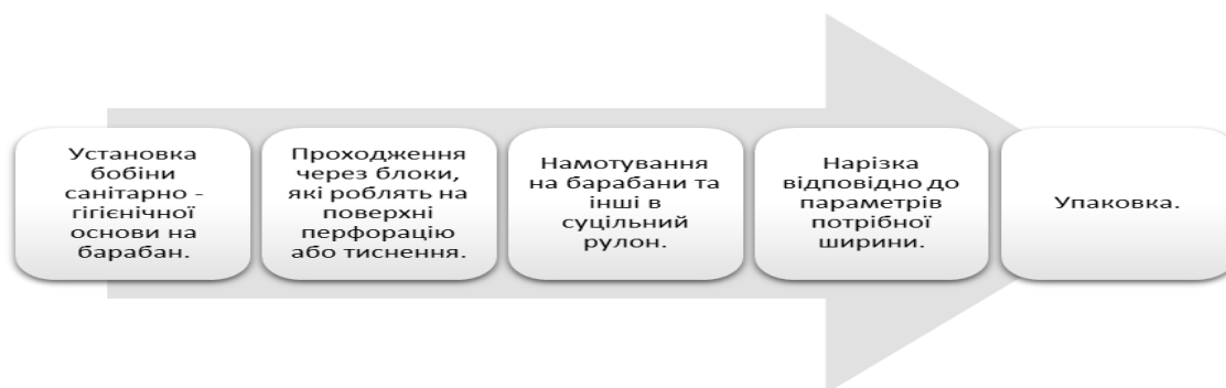
Рис. 3. Етапи виробництва туалетного паперу.
